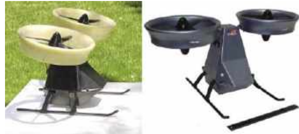
شکل ۳۲- پرنده دوپره با ملخ محصور ناسا و شرکت Trek [43]
