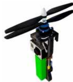
شکل ۲۰- نمونه ای از پرنده تک پره با بردار رانش متغیر به همراه یک دوربین [22]
