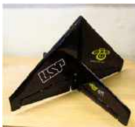
شکل ۸۵- پرنده شبه دم نشین موسوم به شارکی طراحی شده توسط کورونل (بدون موتورها) [109]
