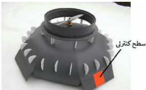
شکل ۲۵- بالک‌های تعبیه شده برای کنترل پرنده کواندا
