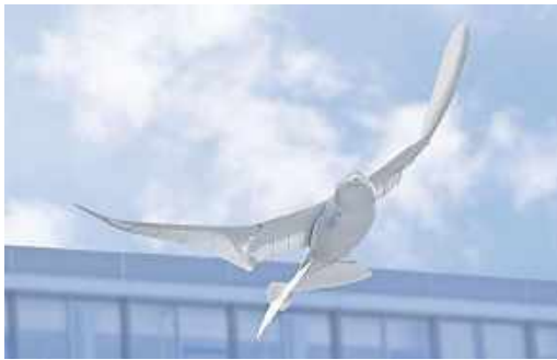
شکل ۱۲۱- پرنده بالزن شرکت فستو با الهام از مرغ دریایی [152]
