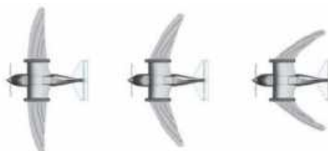
شکل ۵- نمونه ای از یک بال با زاویه پسگرایی متغیر [8]
