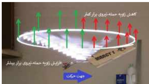
شکل ۵۹- سازوکار گام سیکلی در پرنده‌های بال‌پره
