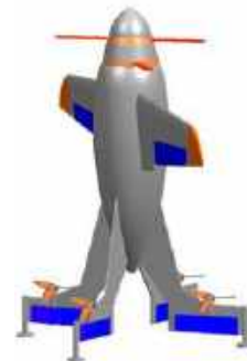
شکل ۷۱- پرنده دم نشین طراحی شده توسط وانگ و همکارانش [92]
