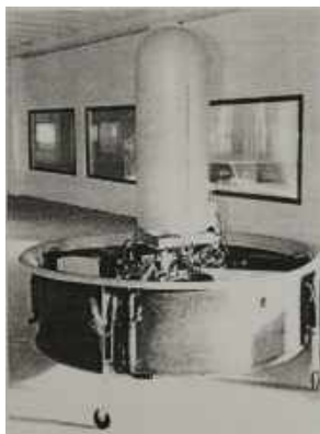
شکل ۲۶- پرنده عمودپرواز فن محصور شرکت AD&D Hornet [36]
