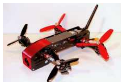
شکل ۴۳- نمونه ای از پرنده‌های چهارپره با پره‌گردان
