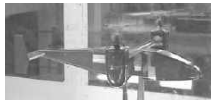
شکل ۸۷- پرنده ساخته شده توسط محققان دانشگاه نانچینگ در تست تونل باد [111]
