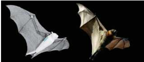
شکل ۱۲۰- پرنده بالزن شرکت فستو با الهام از خفاش [151]
