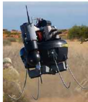
شکل ۲۸- پرنده تک پره با فن محصور شرکت Honeywell [39]
