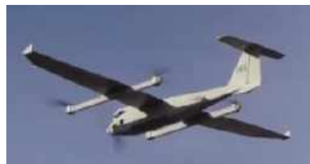
شکل ۱۰۶-پرنده ترکیبی با مجموعه دوگانه Arcturus موسوم به Jump20 [130]
