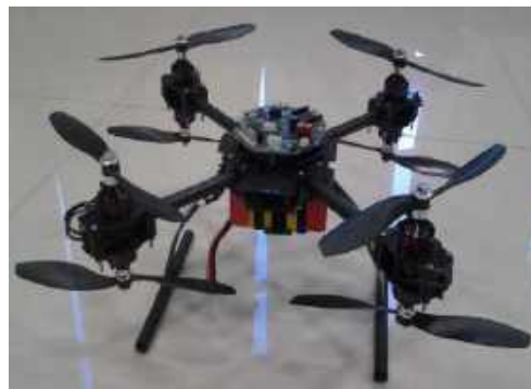
شکل ۴۱- پرنده چهارپره هم محور زرافشان و همکارانش [53]
