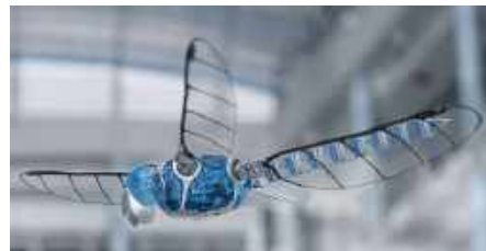
شکل ۱۱۷- پرنده بال زن سنجاقک شرکت فستو [149]
