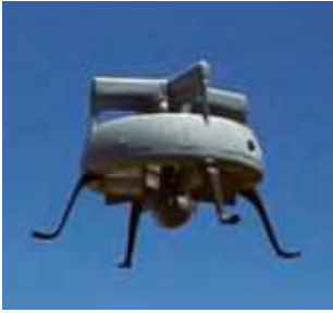
شکل ۲۹- پرنده تک پره با فن محصور شرکت Finmeccanica [38]
