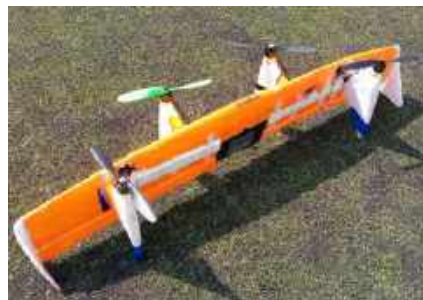
شکل ۸۱- پرنده شبه دم نشین توسعه داده شده توسط ریس و همکارانش [103]
