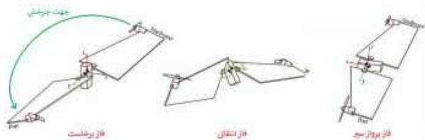
شکل ۱۰۱- فازهای مختلف پرواز پرنده بال گردان و بال پره لو و همکارانش [127]
