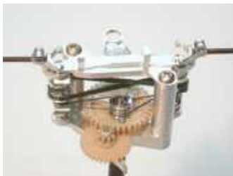
شکل ۱۱۳- مکانیزم بال زن در پرنده مرغ مگس خوار [143]
