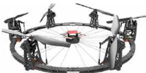
شکل ۵۱- نمونه ای از شش پره با پره گردان توسعه داده شده توسط ریل و همکارانش [67]
